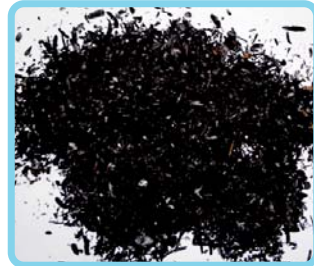
Figura 2.4. Carbón vegetal como reemplazo de la turba en la biomezcla
