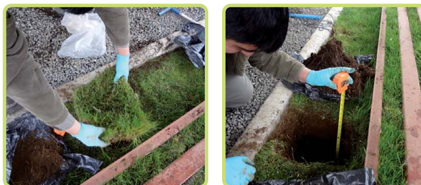
Figura 5.7. Muestro de la biomezcla para el análisis de residuos de plaguicidas
