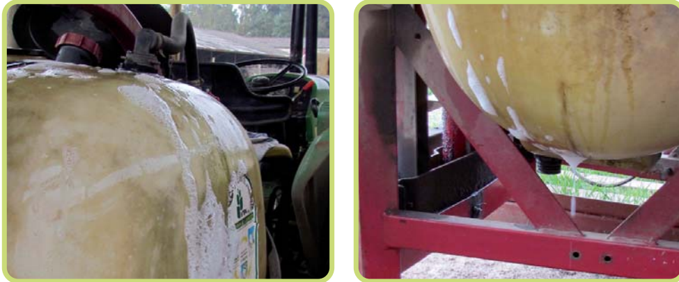
Figura 5.2. Rebalse del estanque durante la preparación de plaguicidas
