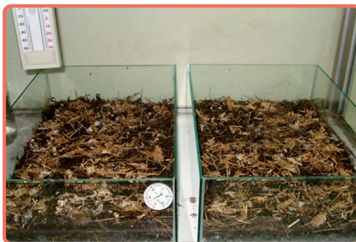
Figura 6.1. Lecho biológico a escala de laboratorio utilizado para evaluar la degradación de plaguicidas
